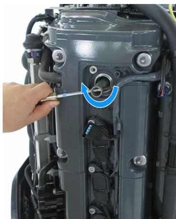
10. Installare manualmente e con attenzione le candele per evitare di incrociare le filettature. Dopo avere montato la candela serrare di  $1/8$ — $1/4$  di giro. Montare le bobine di accensione, collegare i connettori per fili alle bobine di accensione. Installare il coperchio copricandele.
