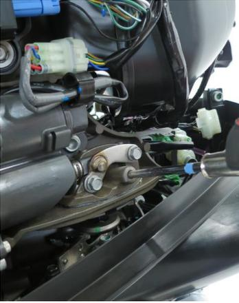
4. Inserire il cacciavite a stella con l'impugnatura del kit nel foro del perno del cambio.
