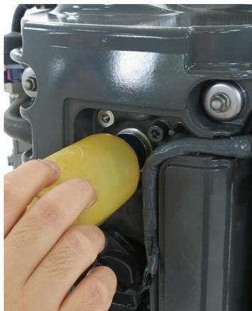
9. Versare un cucchiaino di olio motore in tutti i fori delle candele per lubrificare l'interno dei cilindri.
